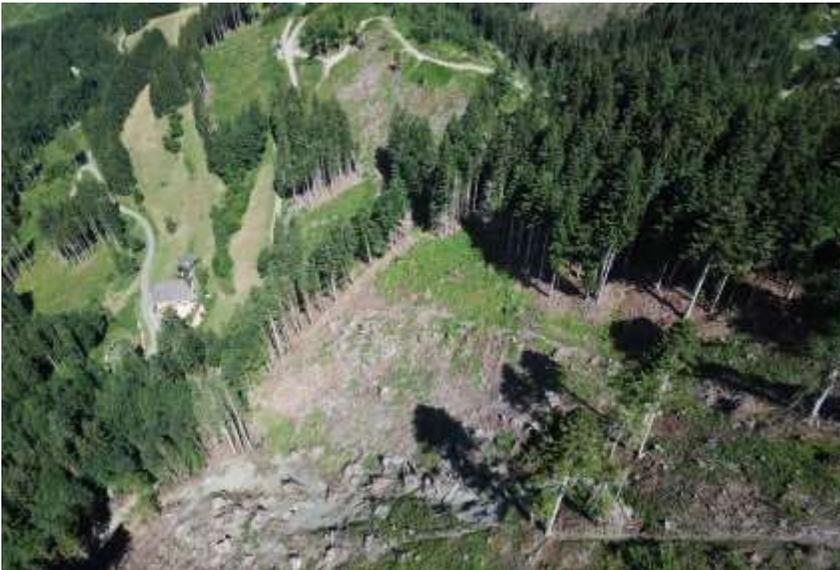
*Abbildung 2: Schrägluftaufnahme auf eine junge Kahlfäche im steilen Hangbereich. Hier hat sich die Vegetation noch nicht geschlossen und das Erosionsrisiko ist als sehr hoch einzustufen.*
