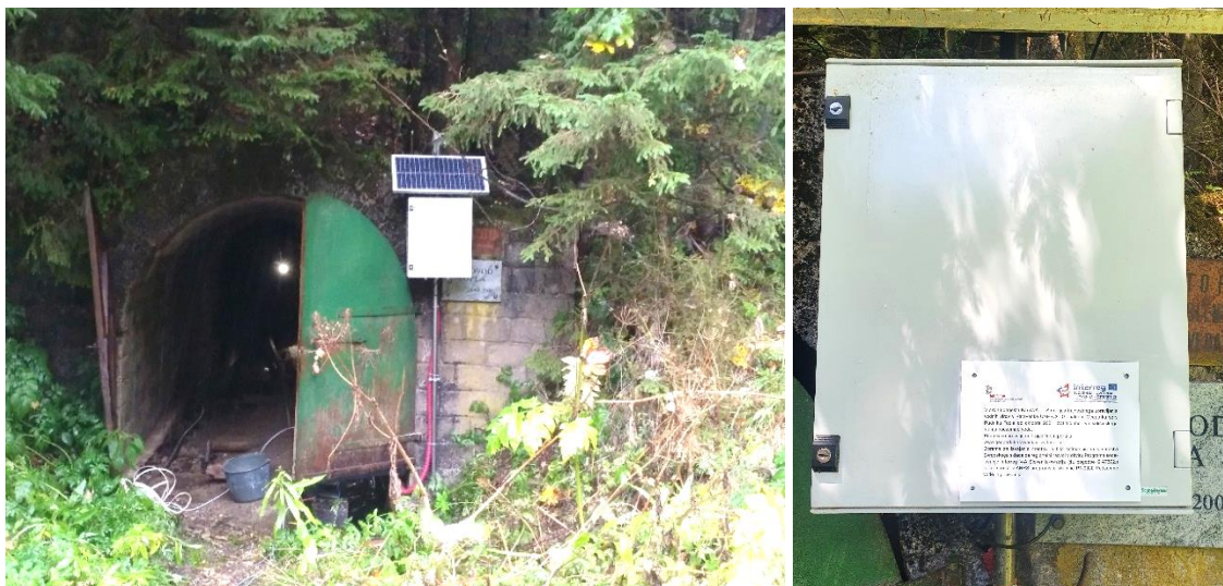
Slika 20: Nameščen registrator in sončne celice za energijo pred vhodom v rudnik in nameščena info tabla o financiranju nakupa.
