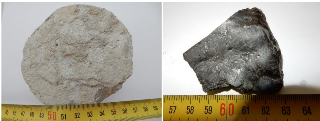
Slika 13: Izgled jedra iz vrtine Sob-4: vodonosnega slabo sprijetega peščnjaka na 890 m globine (levo) ter neprepustne metamorfne kamnine na dnu vrtine na globini 1197 m (desno). Foto: N. Rman
