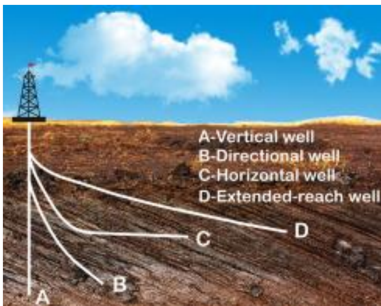
Slika 2: Tipi vrtin glede na metodo vrtanja. Vir: https://link.springer.com/article/10.1007/s40948-016-0038-y .
